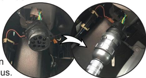
**Dispositivo OBD:** Conecte el cable OBD con el dispositivo, entonces enchufe el dispositivo en el puerto OBD II.
